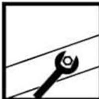
Konstruktion regelmäßig inspizieren und Schrauben nachziehen!
